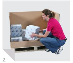
Das erste Seitenteil kann schnell und einfach durch nur eine Person aufgerichtet werden. Die niedrige Ladekante ermöglicht eine einfache Bestückung.
