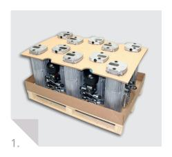
Basisladungsträger zur Fixierung von Motoren.
